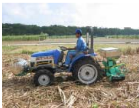
図-2 改良型株出し管理機 (15 馬力) (肥料タンク+株揃え部)
