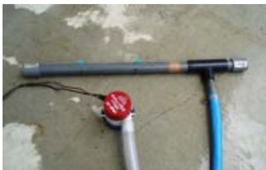
図-5 ビルジポンプと自作噴口
